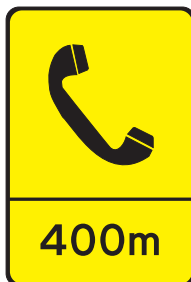
ST12 (TV3) Telefone de emergência 900 x 1300 mm.
