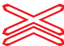
A32b Local de passagem de nível sem guarda com duas ou mais vias
