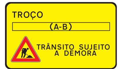
ST11 (TV2) Trânsito sujeito a demora A = Nó início do sublanço; B = Nó fim do sublanço 2300 x 1450 mm.
