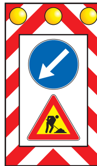
ET 12 Atrelado de balizamento.
